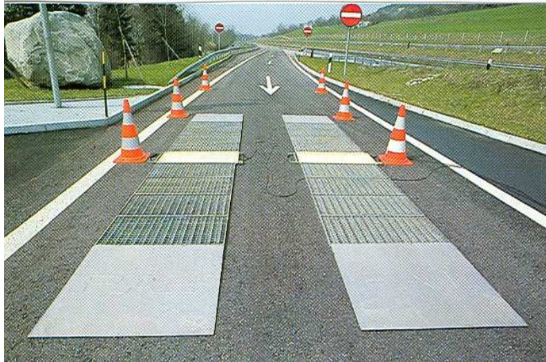
Rysunek 5.3 Przenośny system ważenia, (IMEX-Bis Sp. z o.o.)
