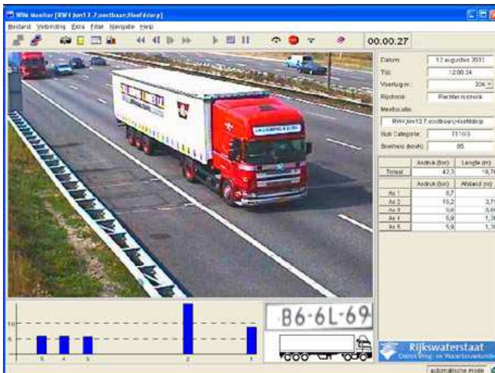
Rysunek 5.5 Obraz danych komputerowych uzyskanych z punktu pomiarowego WIM, (Dienst Weg – en Waterbouwkunde)
