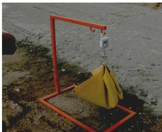
Ważenie tacki pomiarowej ze spoiwem
