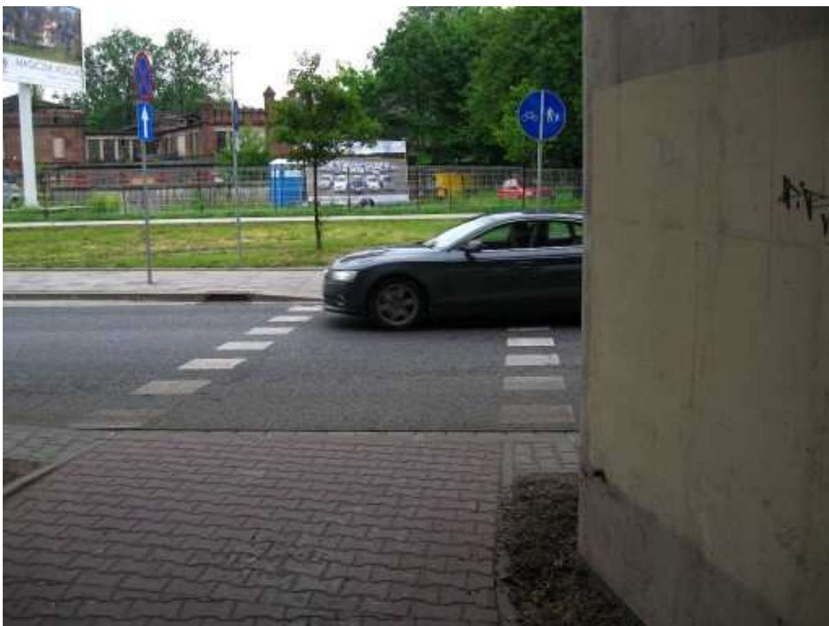
Rys. 6. Wadliwie oznakowany przejazd dla rowerzystów przez wlot średniego ronda z dwoma pasami ruchu. Filary wiaduktu całkowicie ograniczają widoczność. Jest to poważny błąd projektowy. W konsekwencji tego błędu w tym miejscu wskazane jest wyjątkowo odebranie rowerzystom znakami drogowymi pierwszeństwa wynikającego z art. 27 ust. 1a ustawy Prawo o Ruchu Drogowym znakiem B-20 „stop”.
