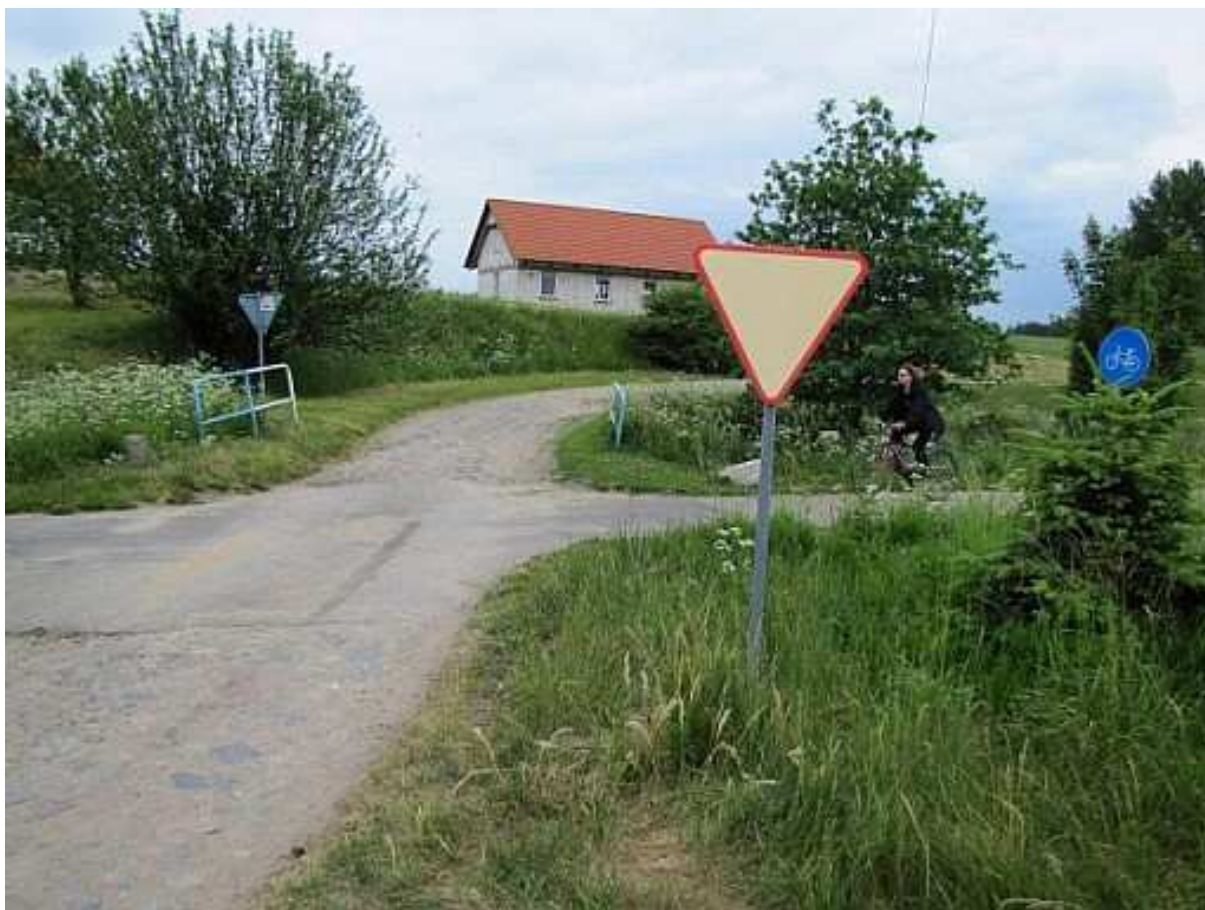
Rys. 3. Samodzielne skrzyżowanie drogi dla rowerów z drogą ogólnodostępną. Droga dla rowerów Połczyn Zdrój – Złocieniec (woj. zachodniopomorskie). Tu pierwszeństwo znakami odebrano pojazdom na drodze ogólnodostępnej. Zwraca uwagę brak oznakowania poziomego i znaków D-6a.
