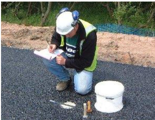
Rysunek 2 Pomiar głębokości tekstury metodą piasku kalibrowanego 1
