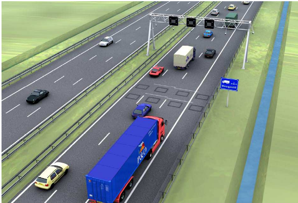
Rysunek 5.4 Wizualizacja punktu pomiarowego WIM, (Dienst Weg – en Waterbouwkunde)
