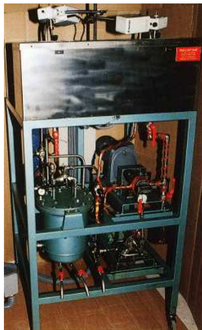
Zdjęcie 1. Młynek emulsyjny wraz z instalacją
