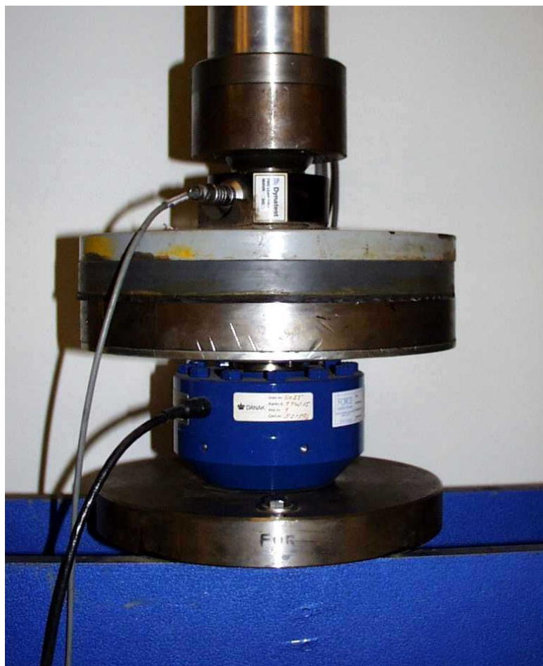
Rysunek 2 Zdemontowany czujnik siły FWD oraz wzorcowy czujnik siły przygotowany do kalibracji statycznej czujnika siły
