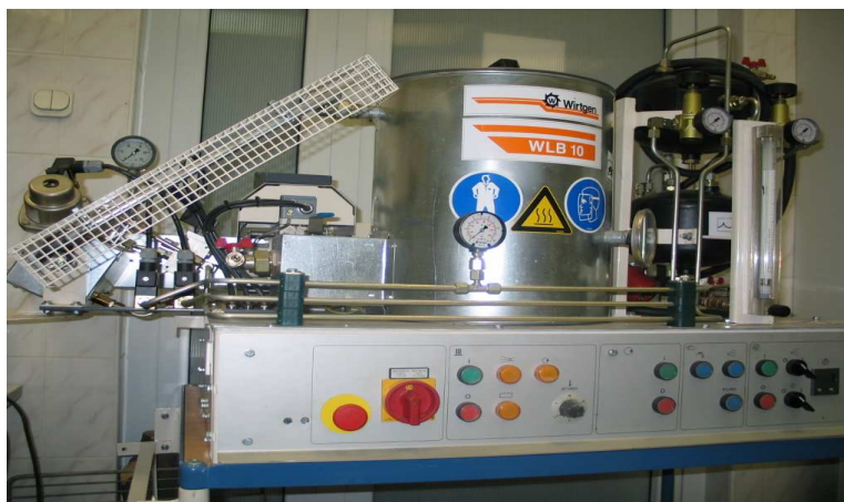
Rys. 8. Laboratoryjny aparat do produkcji spienionego asfaltu
