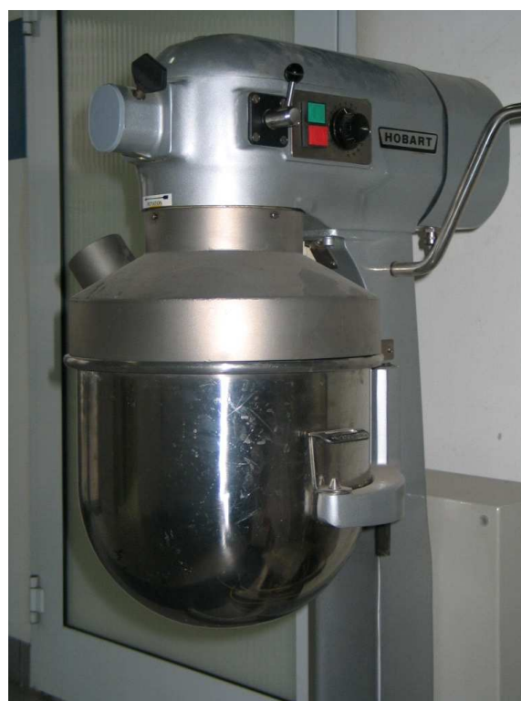
Rys. 2. Mieszadło laboratoryjne HUBART (poj. 20l)
