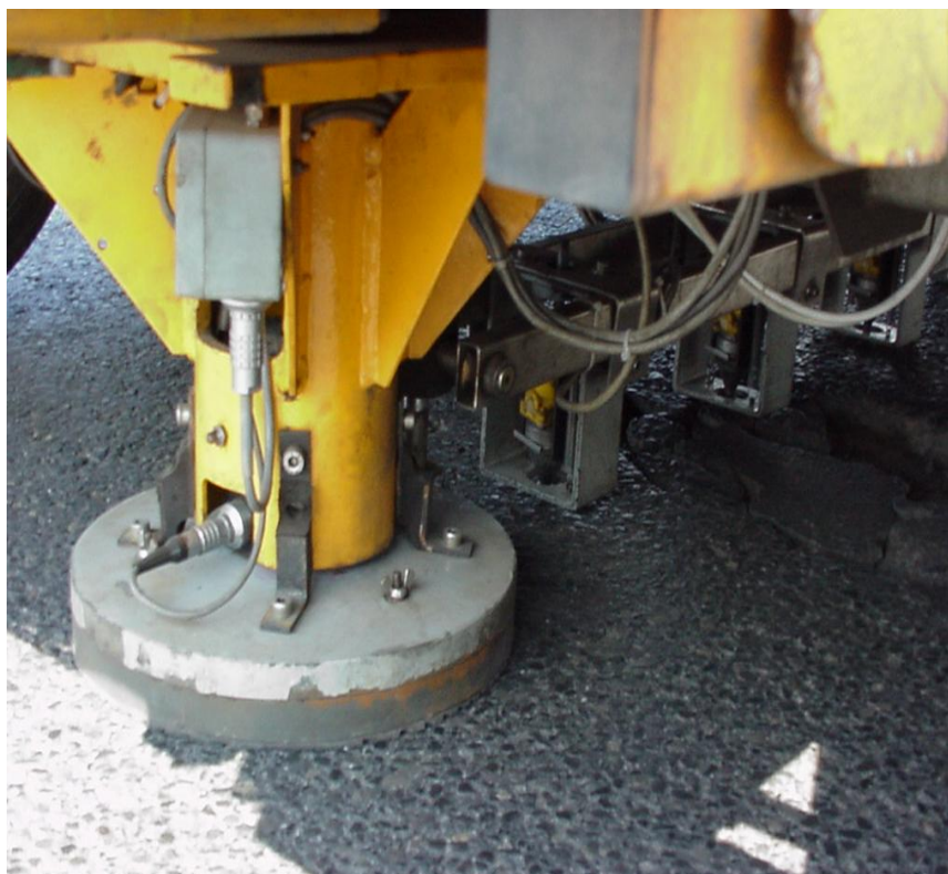
Rysunek 1 Widok ugięciomierza FWD podczas wykonywania badania (na zdjęciu płyta naciskowa i czujniki ugięć, tzw. geofony)
