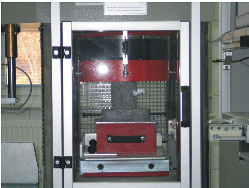
Rysunek 4 Widok próbki podbudowy z betonu cementowego podczas badania wytrzymałości na ściskanie
