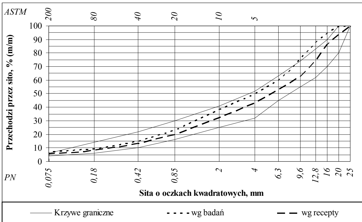
Rysunek 10 Uziarnienie mieszanki mineralnej BA 0/25, z którego została wykonana warstwa wiążąca nawierzchni obwodnicy Trzebnicy (otwory 3+4)
