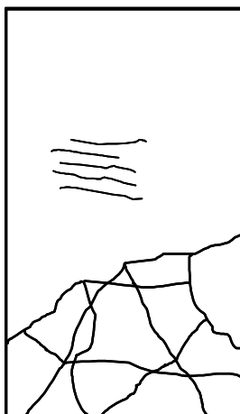
Rys. 7. Schematyczna ilustracja pęknięć powierzchniowych.
