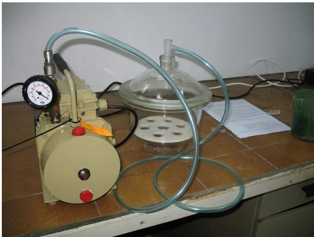
Rys. 4. Widok fragmentu stanowiska do badania gęstości ziarn – pompa próżniowa i estykator.
