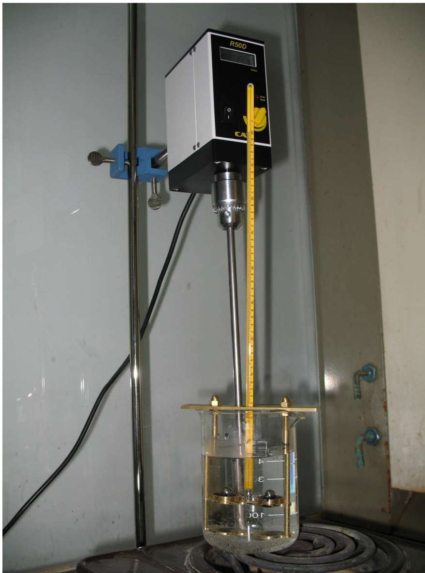
Rys. 5. Widok stanowiska do badania przyrostu temperatury mięknięcia aparatem PIK.
