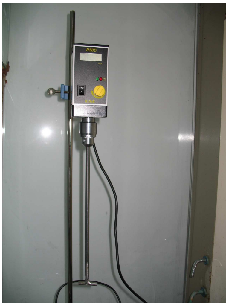
Rys.3. Widok fragmentu stanowiska do oznaczania zawartości wody - mieszadło.
