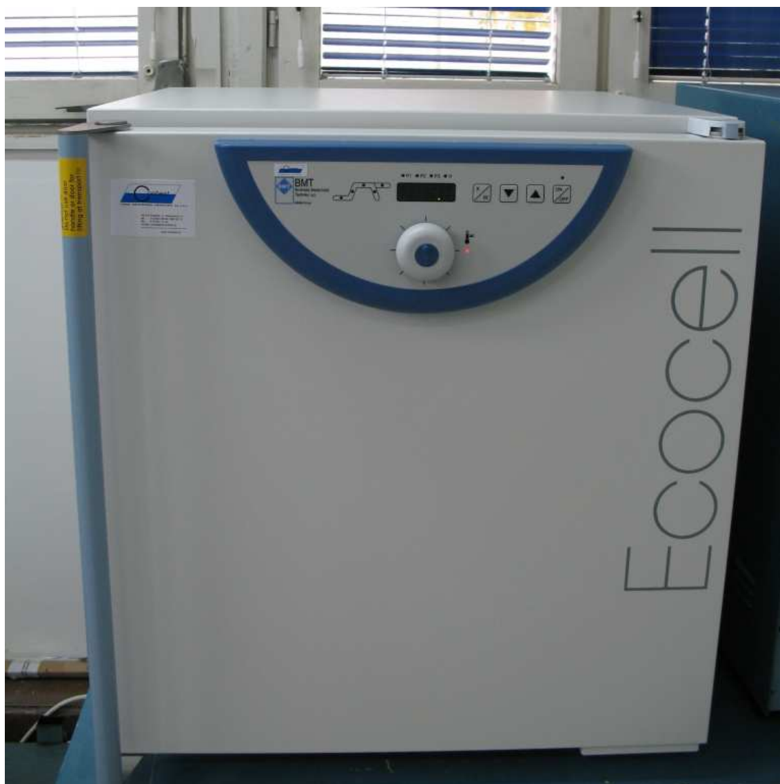
Rys.10. Widok fragmentu stanowiska do oznaczania gęstości wypełniacza - suszarka.
