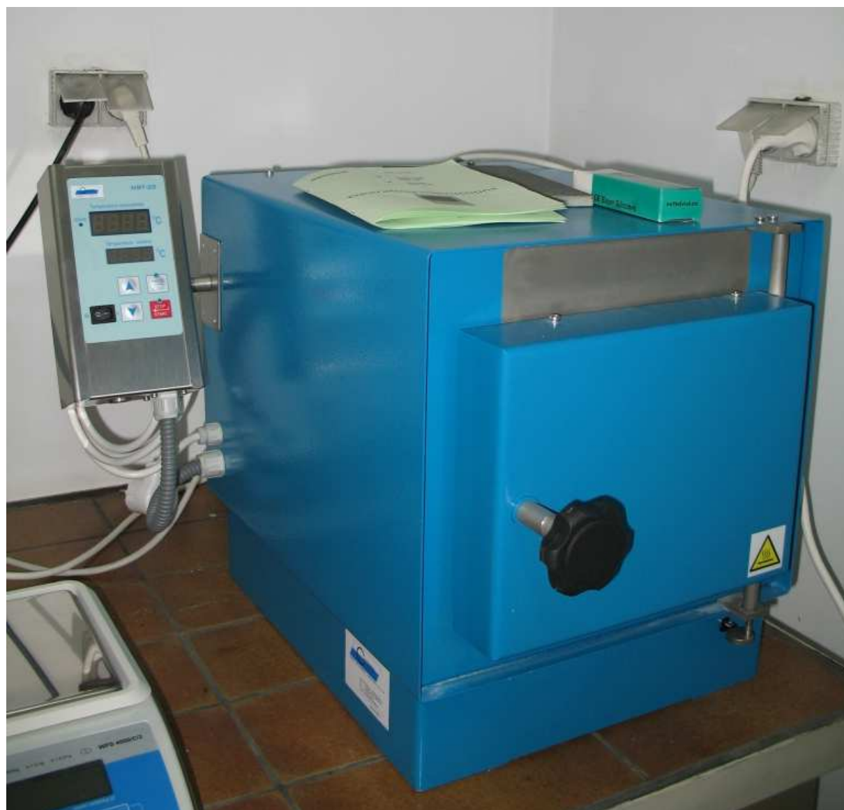
Rys. 8. Elektryczny piec muflowy pozwalający utrzymać wysokie temperatury.
